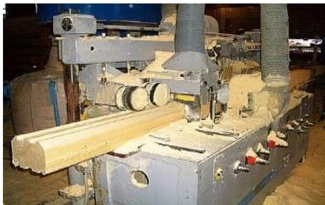
Рис. 1. Изготовление профильного бруса
